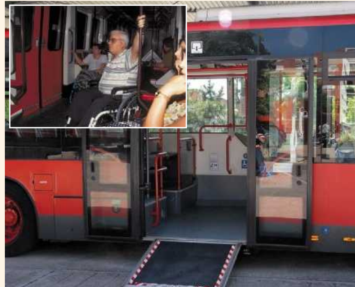
Rampa de entrada para silla de ruedas en autobús accesible.
