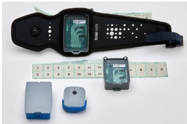
Figura 1. Dispositivo Fesia Walk. A: estimulador, sensor, textil y electrodo multi campo.
